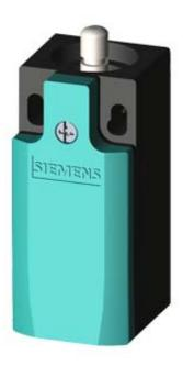
. PLASTIC HOUSING ACC. TO EN50047, 31MM DEVICE CONNECTION 1X(M20X1.5); 1NO/2NC SLOW-ACTION CONTACTS TEFLON PLUNGER
