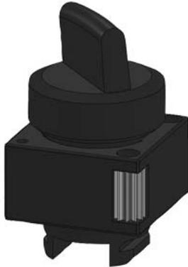
interruptor com manípulo, 22mm, redondo, plástico, preto, manípulo, curto, 2 posições de comutação O-I, de encaixe, ângulo de comutação 50 graus, 11/13UHR, com suporte !!! Produto descontinuado!!! O sucessor é SIRIUS ACT 3SU1 Tipo preferido do sucessor é >>3SU1002-2BF10-0AA0 + 3SU1500-0AA10-0AA0<<
