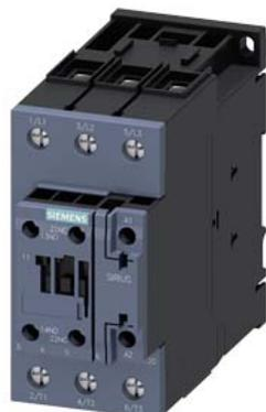
Contator de potência, CA-3 65 A, 30 kW / 400 V 1 NA + 1 NF, 220 V CA, 50 Hz 240 V, 60 Hz, de 3 polos tamanho S2, conexão parafusada
