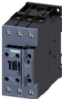
contator de potência, CA-3e/CA-3, 65 A, 30 kW / 400 V, de 3 polos, CA 110 V, 50 Hz, contatos auxiliares: 1 NA + 1 NF, conexão parafusada, tamanho da estrutura: S2
