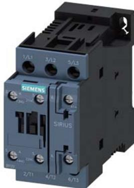
contator de potência, CA-3e/CA-3, 32 A, 15 kW / 400 V, de 3 polos, 12 V CC, contatos auxiliares: 1 NA + 1 NF, conexão parafusada, tamanho da estrutura: S0
