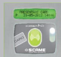
Display LED con lettore RFID integrato
